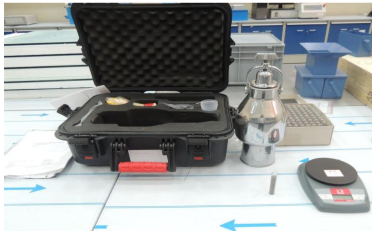
Fig 1.3: Speedy moisture meter
